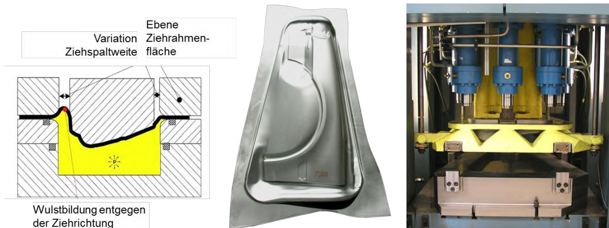
Abb. 42: Modifikation der Ankonstruktion am Beispiel eines hydromechanisch tiefgezogenen PKW-Kotflügels, Blechwerkstoff AA6016 [9]
