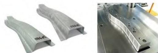
Rückfederungskompensation durch Spannungsüberlagerung bei der Umformung (DFG, EFB - AiF)
