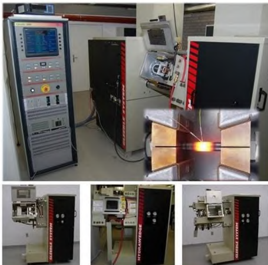
Abb. 10: Abbildung des Thermomechanischen Prüfsystems GLEEBLE 3800C am IFU Stuttgart
